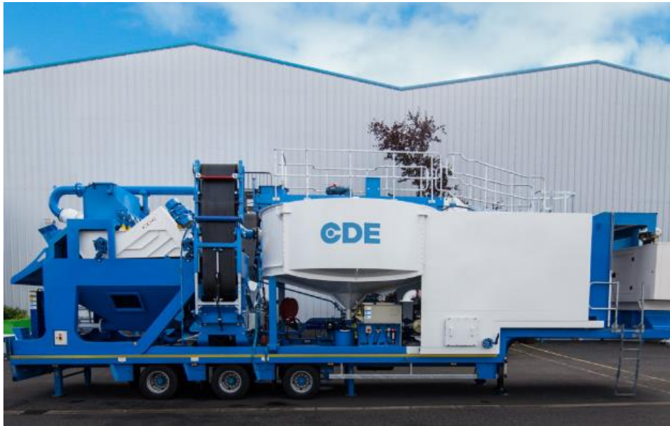
Kuva 1. Mobiili pesu- ja vedenkierrätysjärjestelmä.
